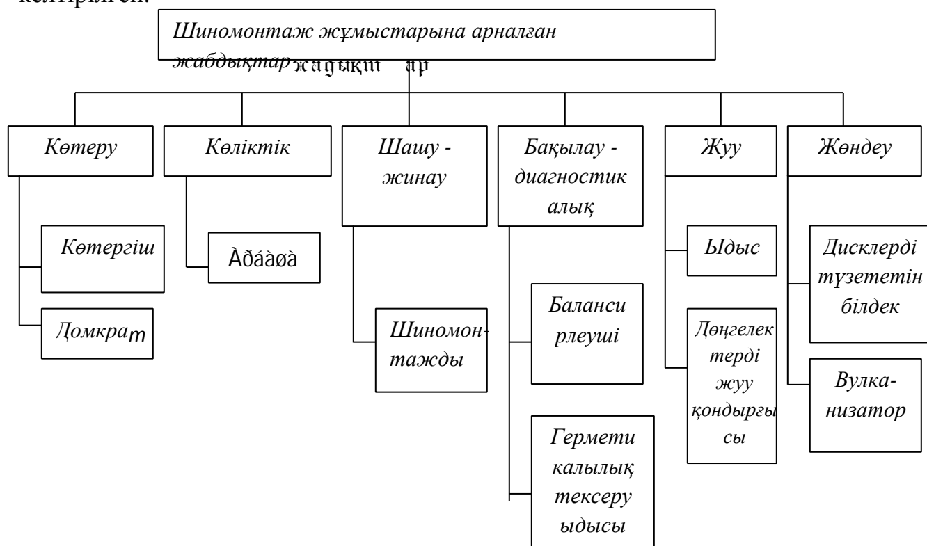
2.1 – сурет - Шиномонтажды кешенді технологиялық жабдықтау сұлбасы
